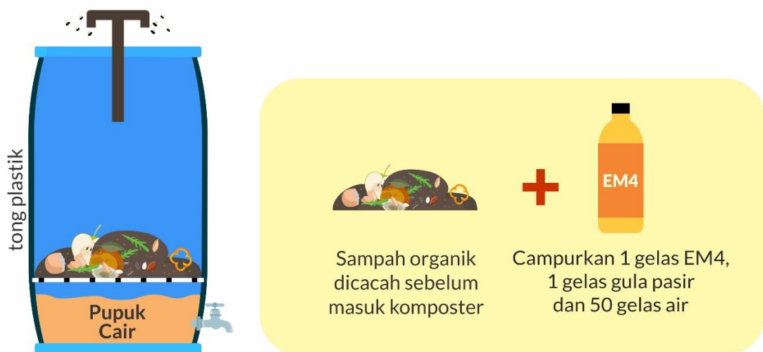
Gambar 2. Pengolahan Sampah dengan Sistem Komposter
